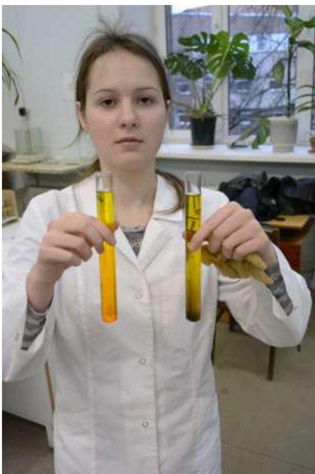
Рис. 2. Работа в лаборатории. Определение углерода методом хемодеструкции
